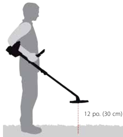
Figure 17 – Position de détecteur correcteur pour Elim. Interférences
